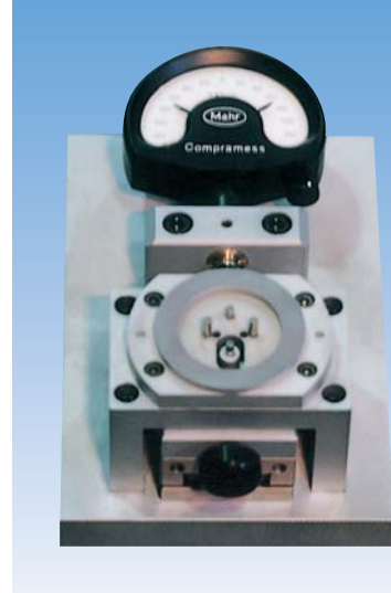
●VTRドラム内径測定機 繰り返し精度2 \mu m
