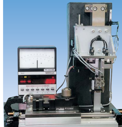
●シリンダー穴円筒度測定機 繰り返し精度0.5 \mu m
