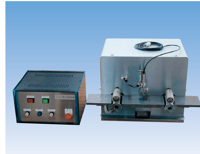
●自動フィルム厚み測定機(ピッチ送り)
