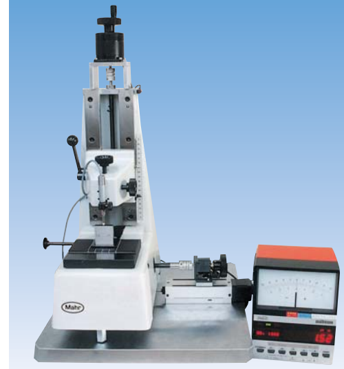
●ブロックゲージ測定機 繰り返し精度0.4 \mu m
